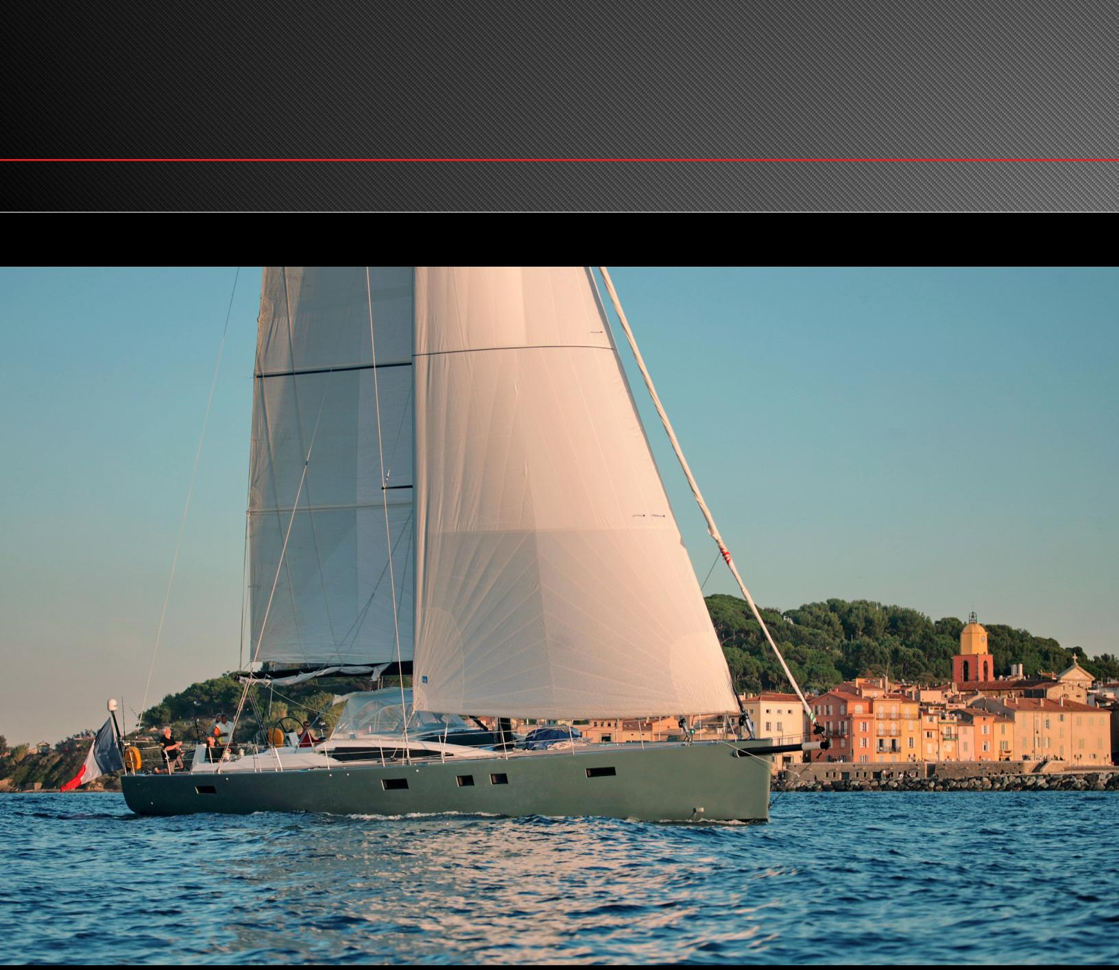
Une carène aux lignes modernes qui permet d'obtenir un bateau performant dérivé des 60' Open des courses autour du monde : entrées d'eau fines, bau maximum reculé, section arrière large et longueur à la flottaison maximum. Ses lignes modernes et esthétiques en font un grand yacht de voyage.
