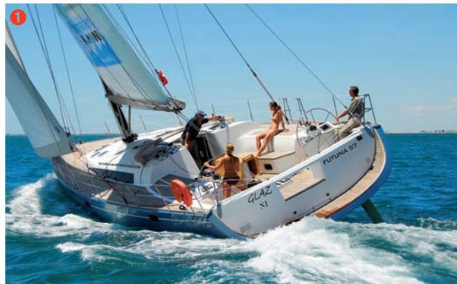
❶ Très large et dotée d'un lest à bulbe profond, la carène inspirée des 60 pieds Imoca gîte très peu. La stabilité de route est exemplaire et le contrôle de barre reste constant à la gîte, grâce aux deux safrans très écartés et angulés.
